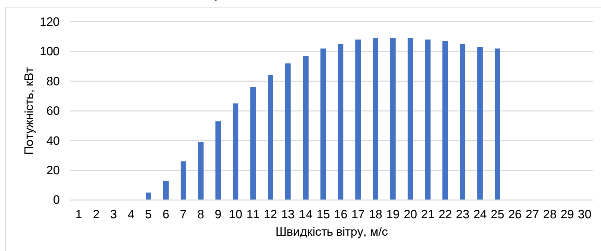
Рисунок 4.11 – Генерація енергії вітровою турбіною потужністю 100 кВт
